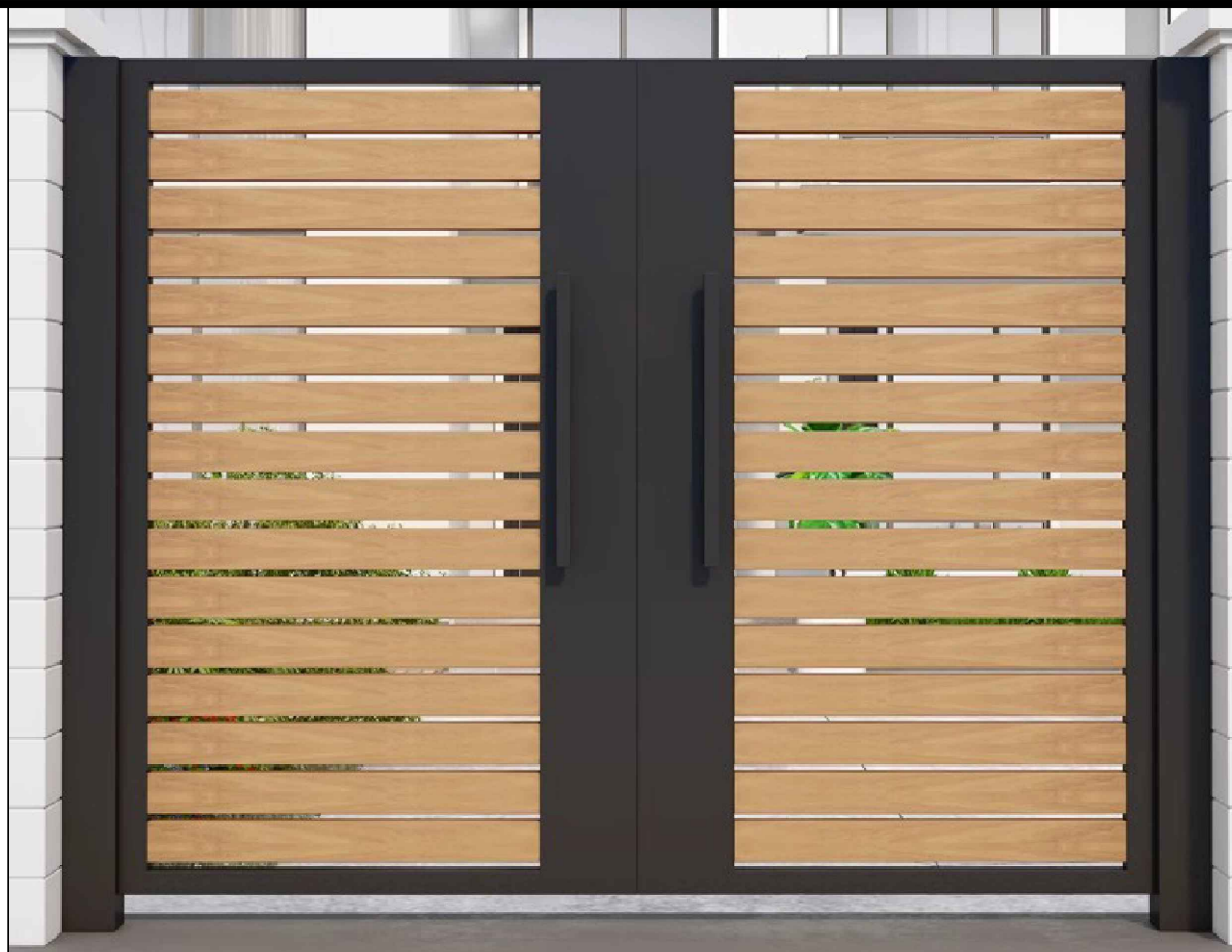
2 铝合金门示意图 1:20 铝合金框+塑木板
